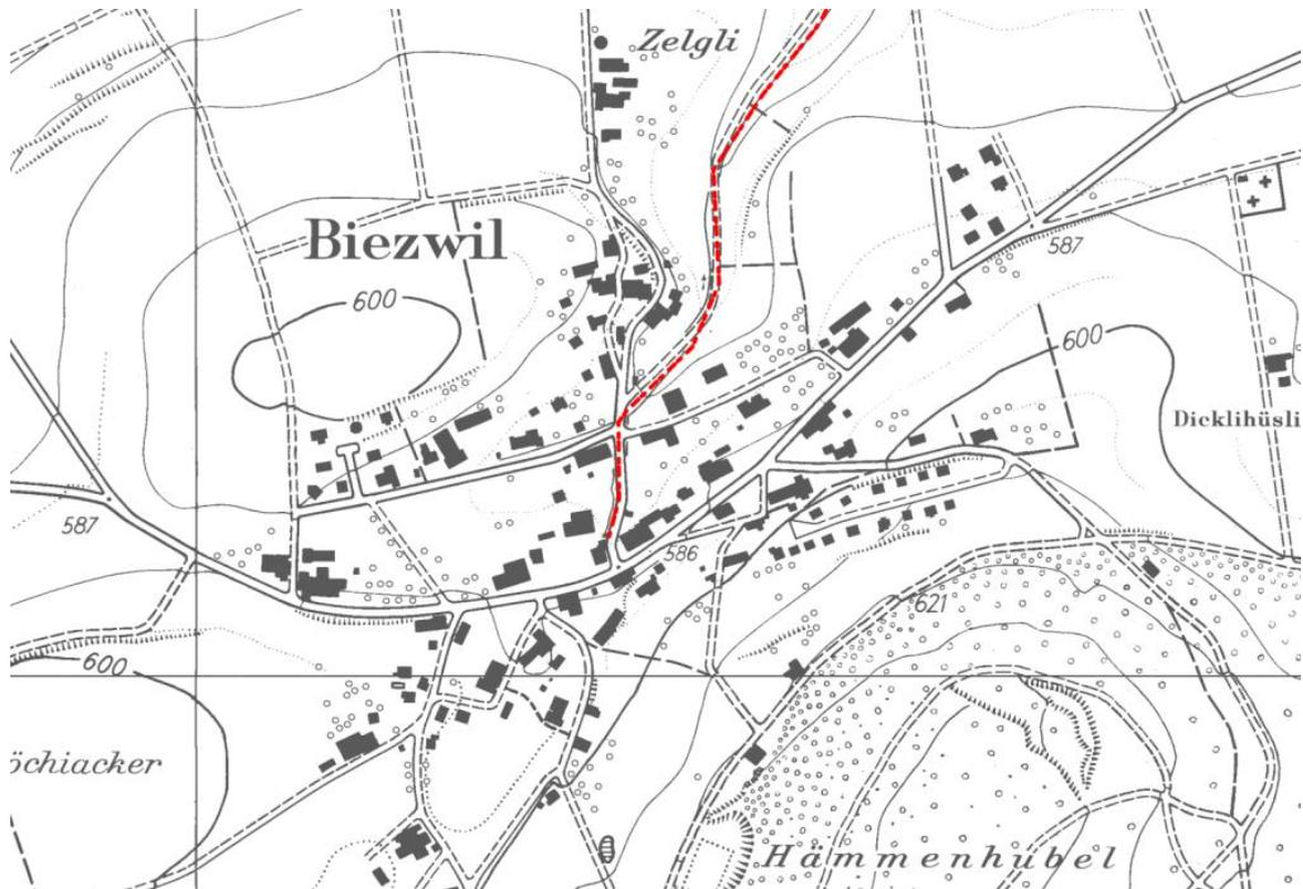
Im unteren Teil des eingedolten Baches wird mit der Ausscheidung einer Uferschutzzone im Gesamtplan der Gewässerraum für eine allfällige Öffnung des Baches sichergestellt. Innerhalb des Siedlungsgebietes verläuft die Eindolung im Strassenraum der beidseitig von bestehenden Bauten flankiert wird. Eine Öffnung des Baches in diesem Bereich wird deshalb als unrealistisch beurteilt und ist nicht vorgesehen.
